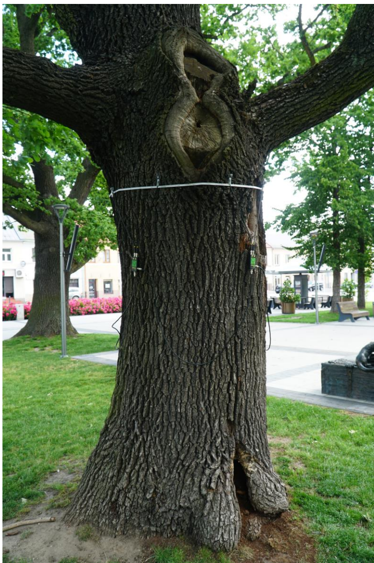
Fot. 3 Badanie tomografem akustycznym wykazało, iż powierzchnia objęta rozkładem wynosi 71% - niskie ryzyko wylamania (fot. T. Łyszcz, dnia 24.06.2015 r.)
