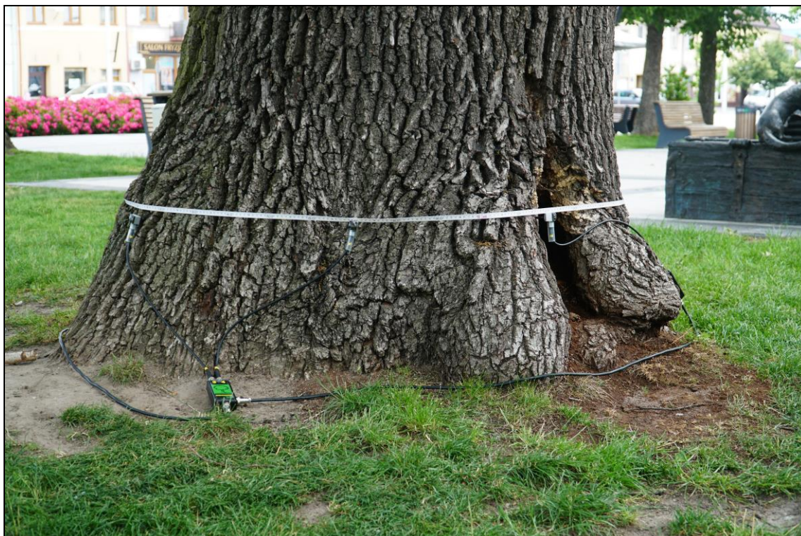
Fot. 2 Badanie tomografem akustycznym wykazało, iż powierzchnia objęta rozkładem wynosi 86% - niskie ryzyko wyłamania (fot. T. Łyszcz, dnia 24.06.2015 r.)
